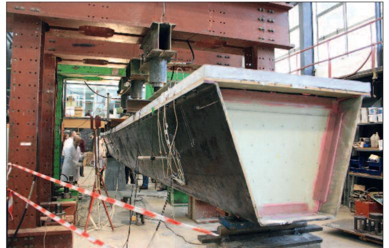
Ensayo a flexión de viga artesana para puente, de fibra de carbono con losa de hormigón
