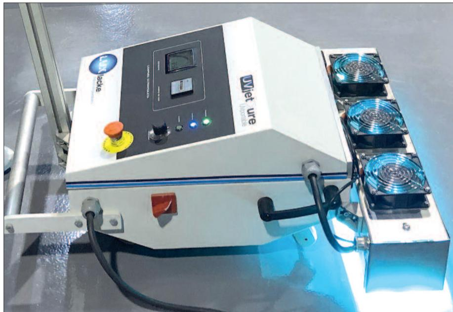
Sistema epoxi para suelos con secado instantáneo por rayos UV
