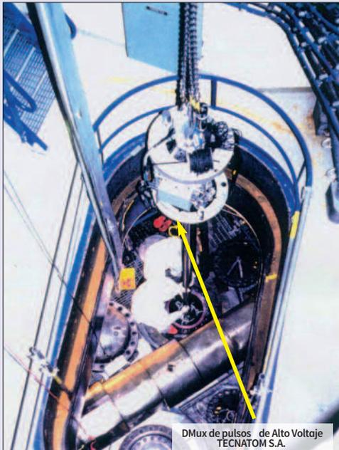
END de Generadores de vapor en una Planta Nuclear de Finlandia (Scanning de excitaciones AT sobre 16 canales - TECNATOM S.A.)
